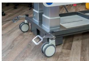
Abb. 10: Rollen Geradeauslauf - Hebel mittig
