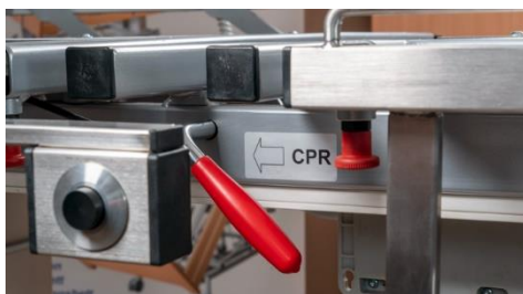
Abb. 12: Entriegelungshebel für manuelle Notabsenkung
