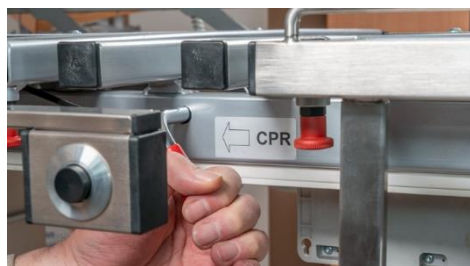
Abb. 12: Entriegelungshebel in Richtung Kopfseite drücken
