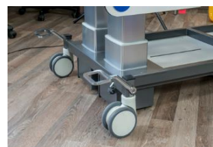
Abb. 10: Rollen ungebremst - Hebel oben
